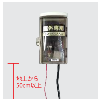
LED専用12V変圧器を設置します。設置する際は、冠水の恐れがないよう地上から50cm以上の場所に取り付け下さい。
