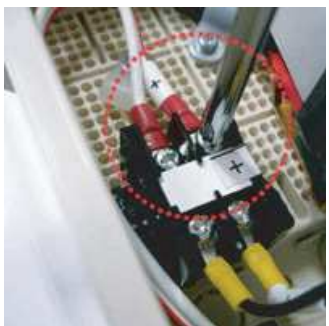
めがね端子の+配線を+表示のある方に接続。もう片方は表示のない側に接続します。ビスはめがね端子リングを通し正しく固定し、透明アクリルカバーをして下さい。
