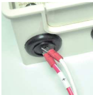
BOX下側のゴム弁切れ込み部分からLEDコードのめがね端子を差し込んで下さい。
